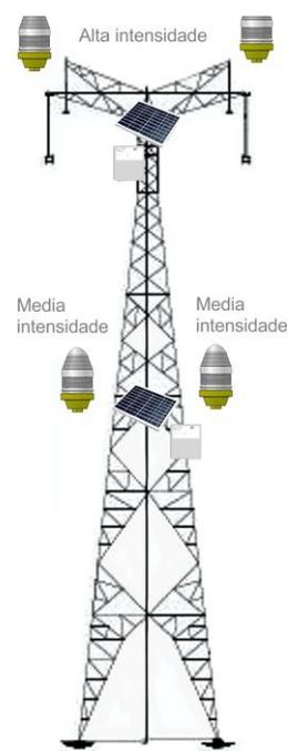
Figura 6 – Ilustrativo de Instalação síncrona a energia solar
